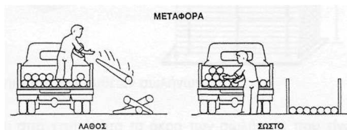
Σχήμα 5: Ανορθόδοξος και σωστός τρόπος φορτοεκφόρτωσης σωλήνων.
