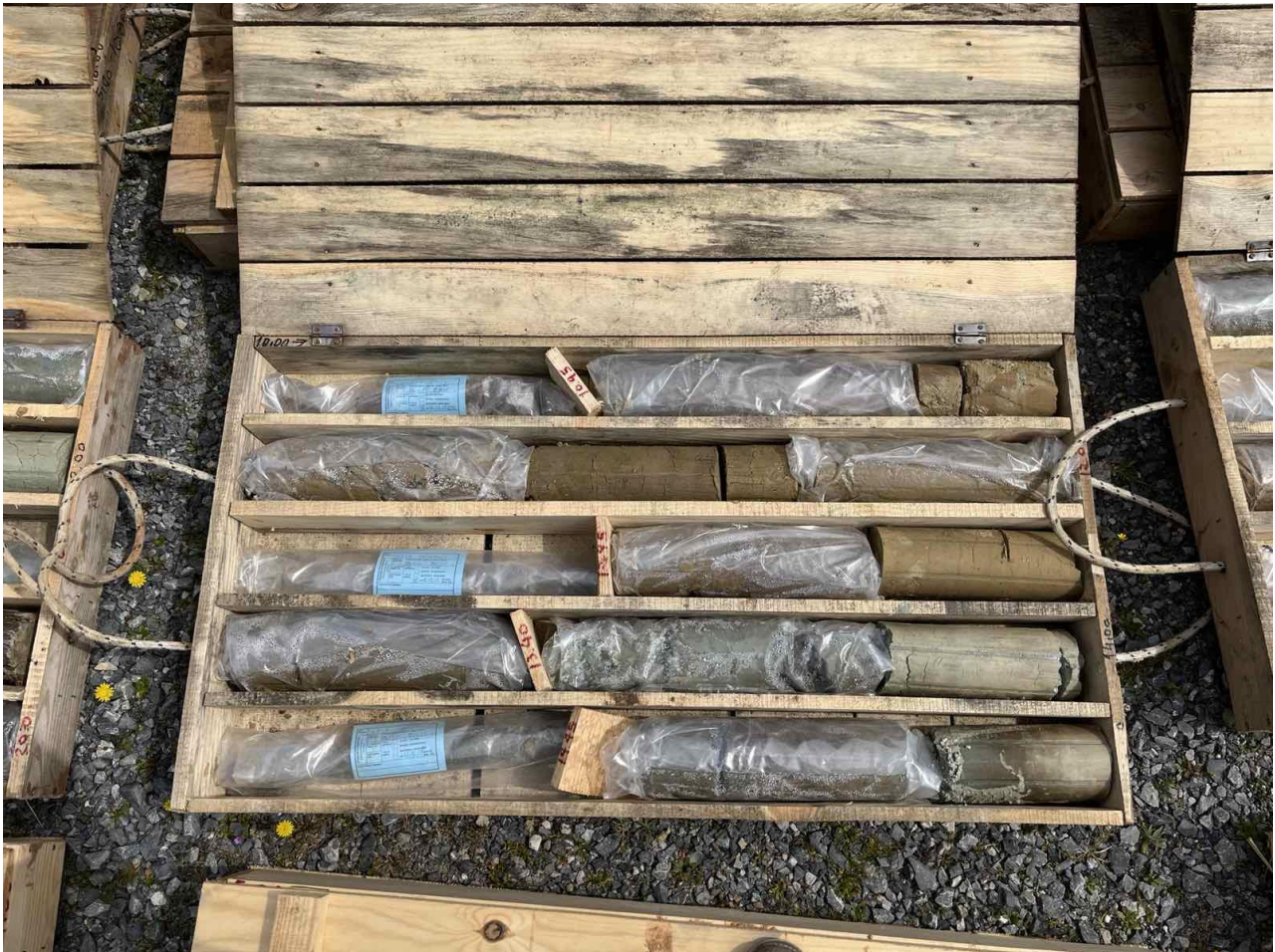
Εικόνα 11 Δειγματοληψία Εδαφικών Σχηματισμών Γεώτρησης Γ1 - Κιβ. 3/4 - Βάθη 10,00-15,00m
