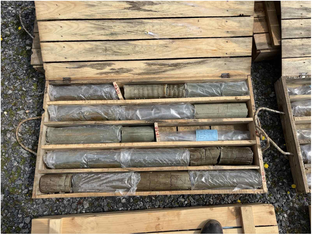
Εικόνα 12 Δειγματοληψία Εδαφικών Σχηματισμών Γεώτρησης Γ1 - Κιβ. 4/4 - Βάθη 15,00-20,00m
