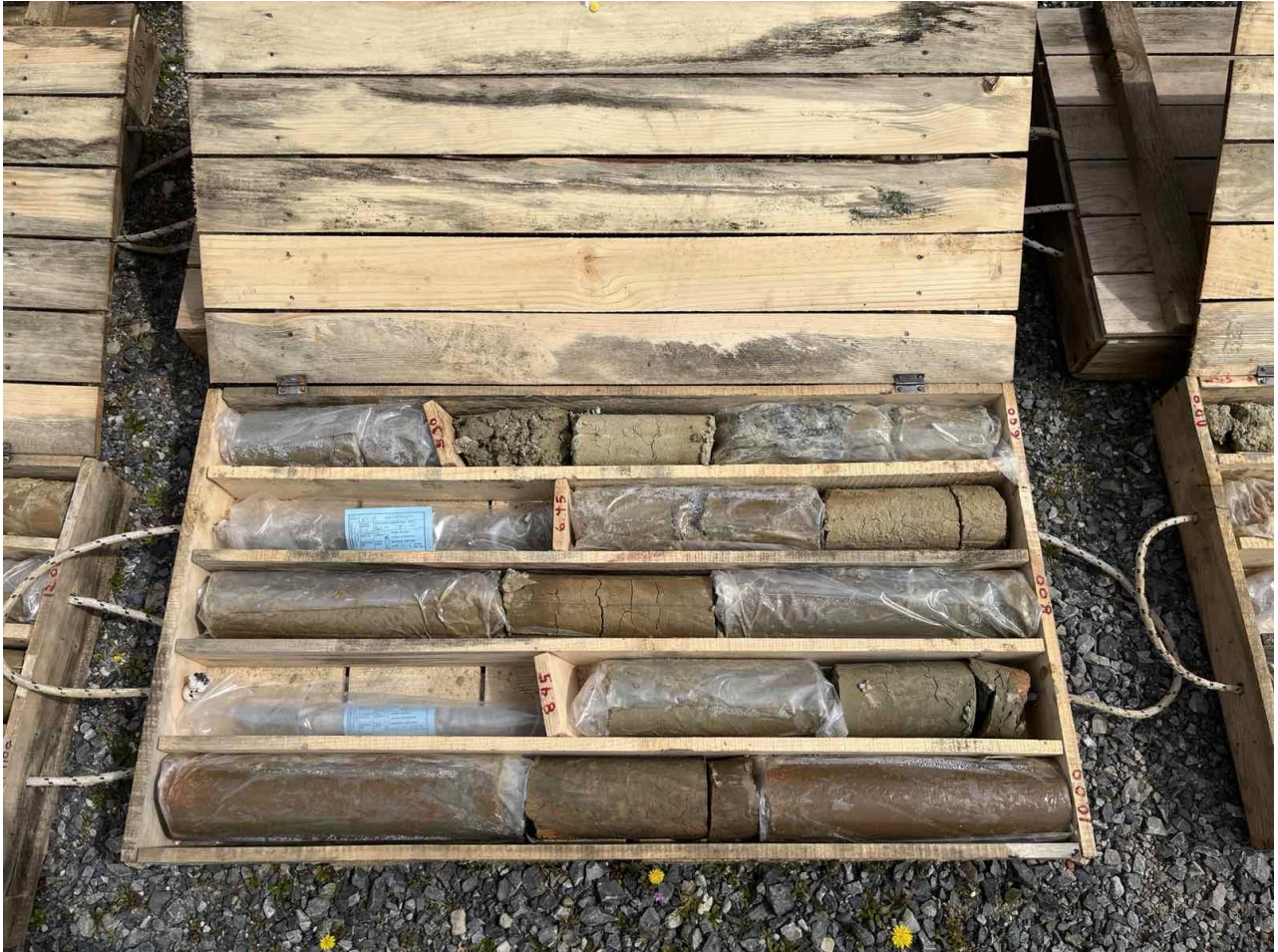
Εικόνα 10 Δειγματοληψία Εδαφικών Σχηματισμών Γεώτρησης Γ1 - Κιβ. 2/4 - Βάθη 5,00-10,00m
