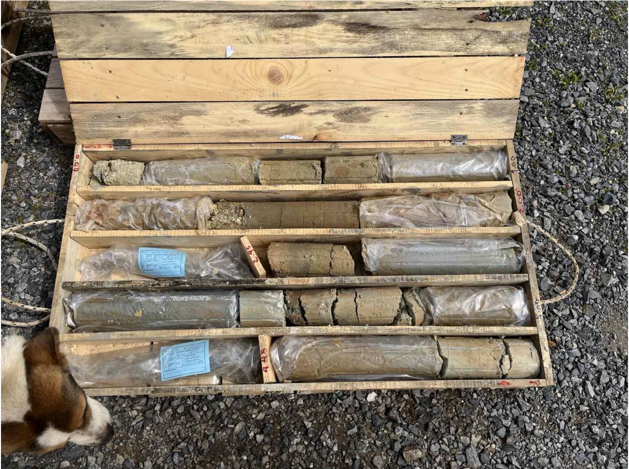
Εικόνα 9 Δειγματοληψία Εδαφικών Σχηματισμών Γεώτρησης Γ1 - Κιβ. 1/4 - Βάθη 0,00-5,00m
