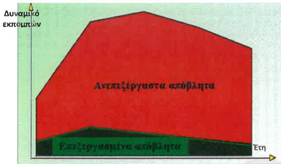
Εικόνα 7-2: Συμπεριφορά κατά την ταφή, επεξεργασμένων και ανεπιξέργαστων ΑΣΑ 1
