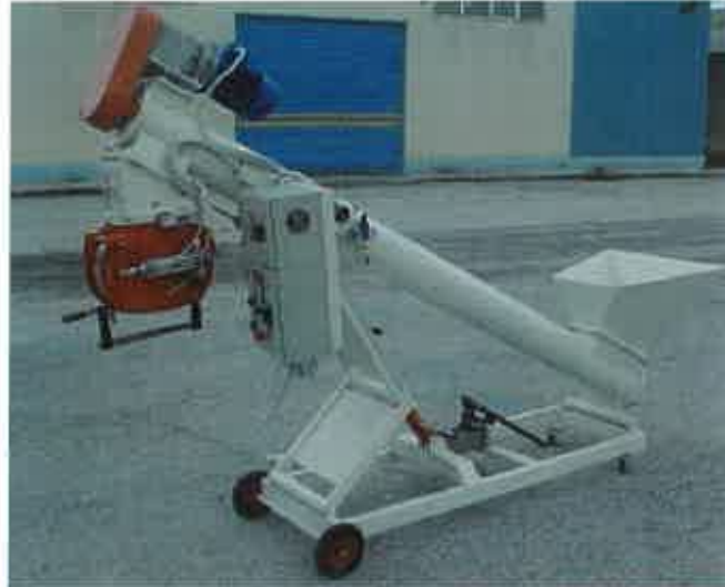
Εικόνα 6-13: Ενσωματωμένη Ζυγιστική Μονάδα Ανοικτού Στομίου
